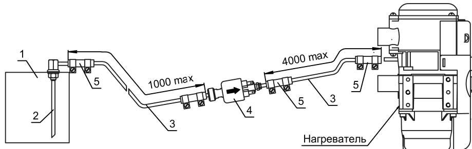
1 Топливный бак      4 Топливный насос
